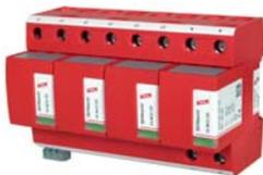
*DEHNventil*: descargador combinado, sobre la base de vías de chispas, compuesto por un elemento base y módulos enchufables. Con tecnología RADAX FLOW, para la limitación de corrientes en la red. Capacidad de 100 KA en onda (10/350) y (8/20). Indicación local de estado de funcionamiento y posibilidad para señalización a distancia.
